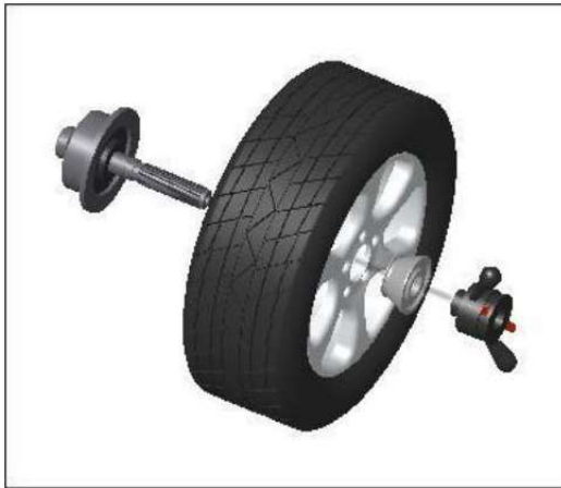
1 Montaż typu: koło-stożek-nakrętka (zalecane do felg stalowych)
